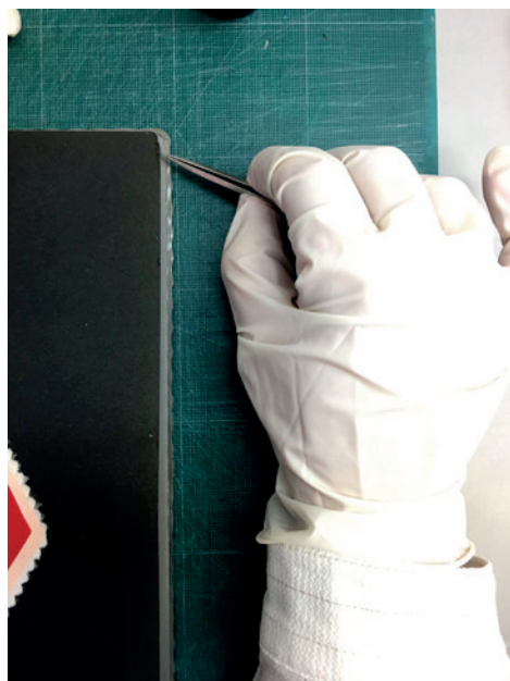
Figura 6. Toma de muestra de fibra de la última hoja en la zona superior derecha.
