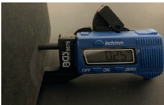
Figura 27. Toma de espesor con ayuda de micrómetro digital, el cual marca 25 mm de en una de las cartulinas que conforman el álbum Ferrocarrilero. coincidiendo con las hojas del álbum IACT.
