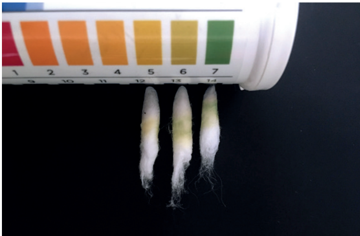
Figura 28. Resultado del pH obtenido de diferentes páginas del álbum encontrado en el Museo Ferrocarrilero de Aguascalientes. Se observa que el pH varía de un cinco, fuertemente ácido a un siete, que es neutro.
